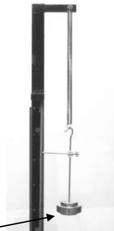
砝碼盤 (功能為可放置砝碼的盤子)
